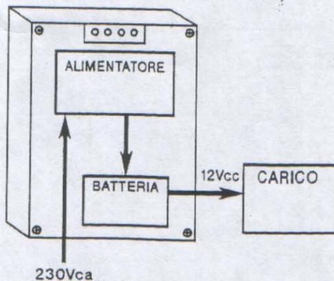
Fig.1-Collegamento del carico
