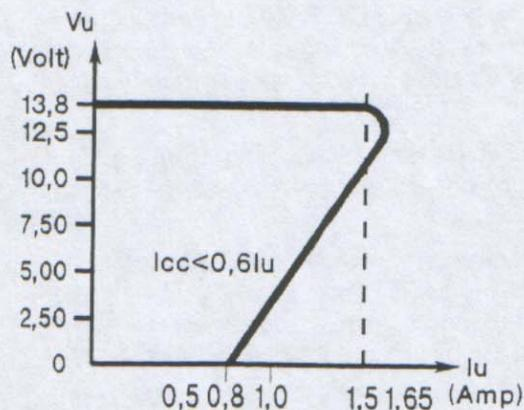
Fig.2-Caratteristica di uscita dell'alimentatore.
