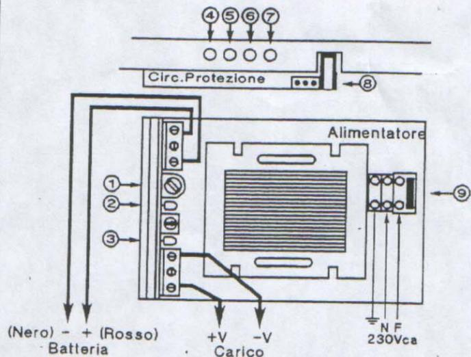
Fig.4-Morsettiera di collegamento.
